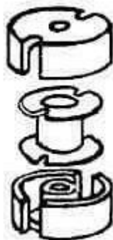
Рис. 2. Составные части конструкции броневой катушки.
